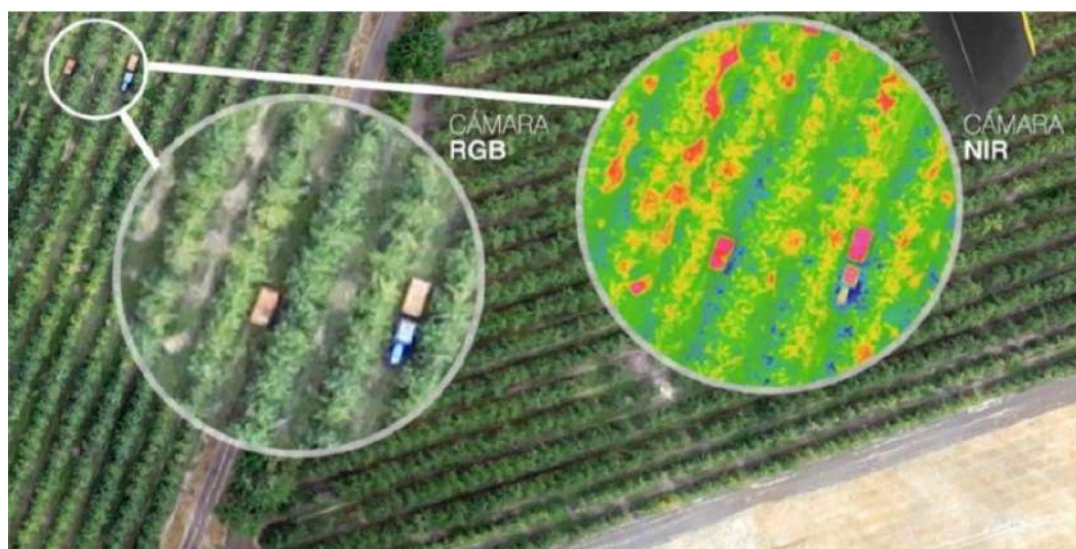
Figura 2. Imágenes según tipos de cámara y espectros (RGB y NIR) (Torres-Rua, 2017).
