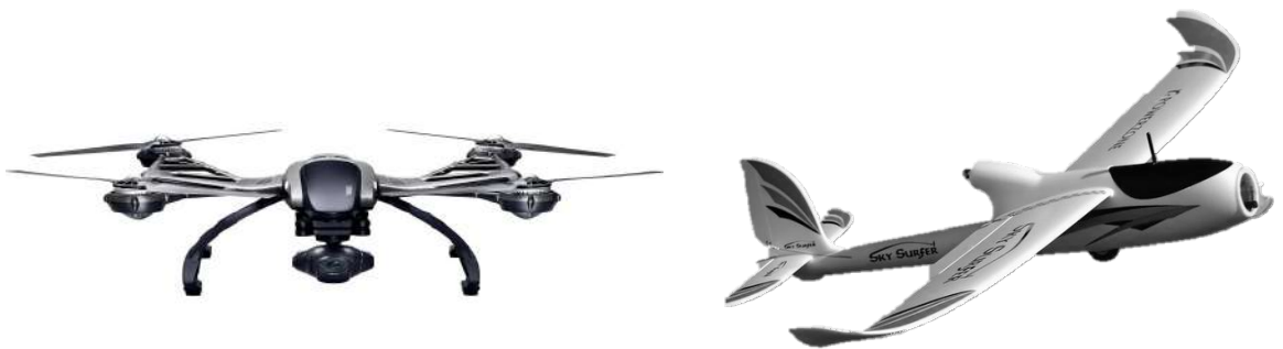
Figura 1 Drones utilizados en la agricultura: (a) multirrotor (cuadricóptero), (b) de ala fija
